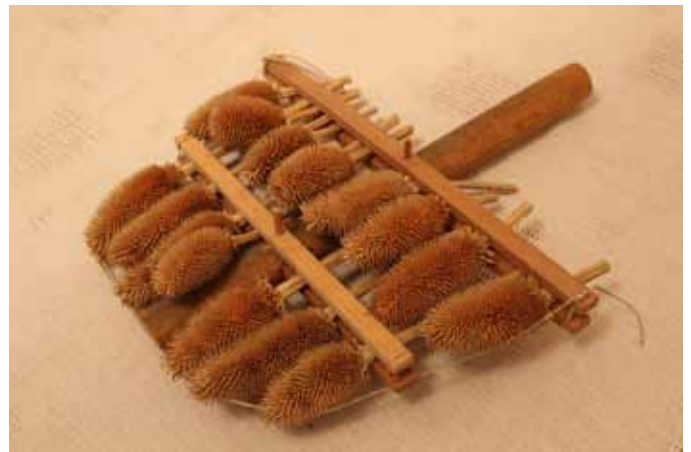
Die Karde wurde zum Aufrauen von Seiden-, Woll- und Lodenstoffen verwendet.
